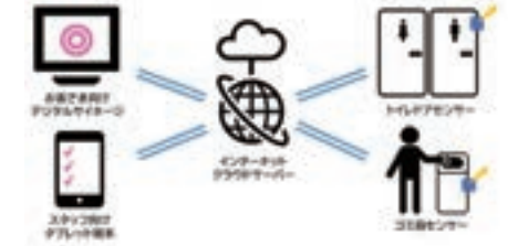
※トイレ・ゴミ箱IoTシステムの構成イメージ
